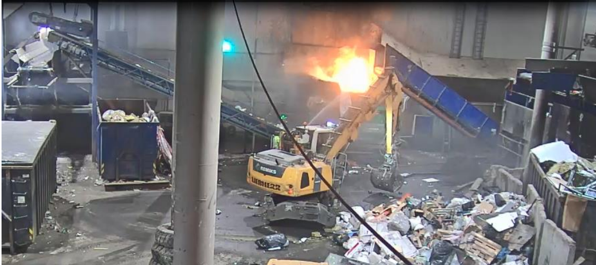
Bilde 1: Branttilløp under kverning av avfall, overvåkningsbilde fra Remiks.
