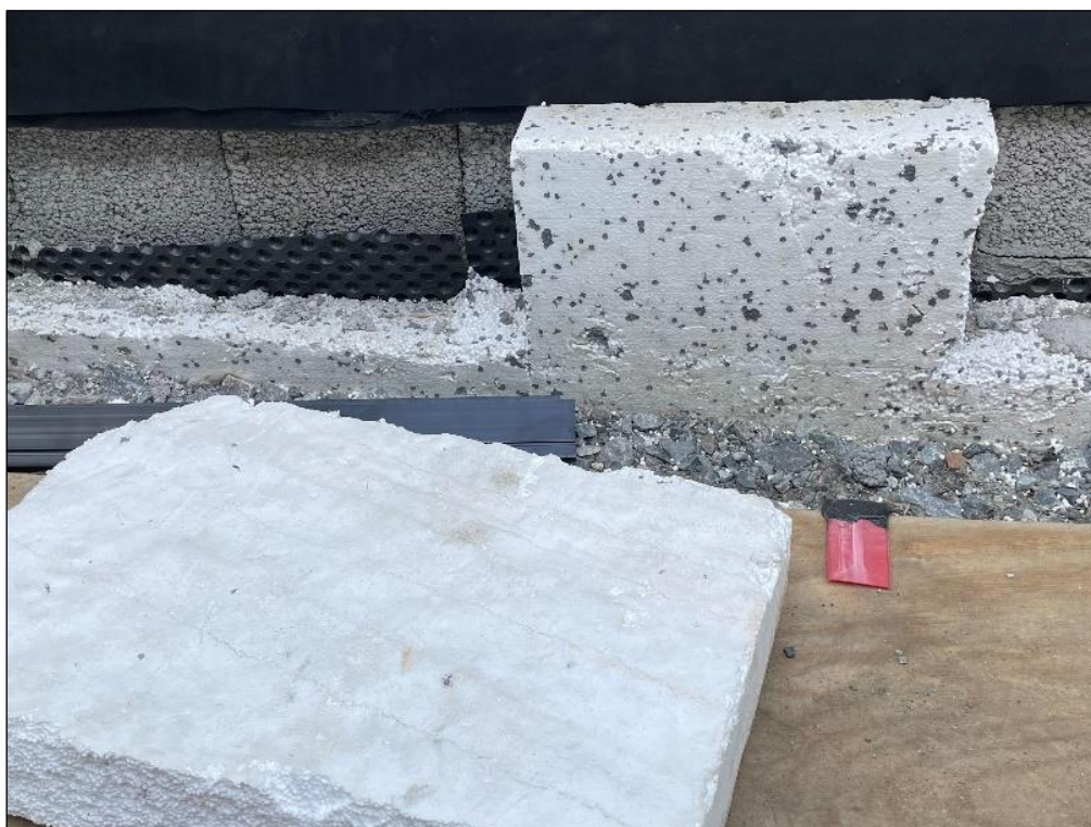
Bilde 4 viser eksempel på EPS/XPS som har begynt å smuldre opp. Små biter kan havne på avveier.
